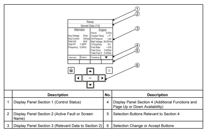
FIGURE 14. GRAPHICAL DISPLAY WITH TYPICAL SCREENSHOT
