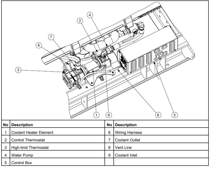
FIGURE 7. COOLANT HEATER
