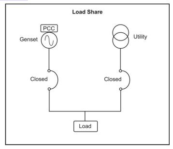
FIGURE 40. MANUAL MODE - CIRCUIT BREAKER CONTROL SEQUENCE 4
