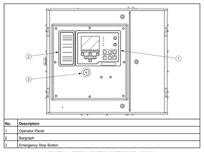
FIGURE 11. TYPICAL CONTROL SYSTEM PANEL (HMI 330)
