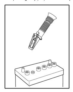
FIGURE 73. TYPICAL BATTERY ACID REFRACTOMETER
