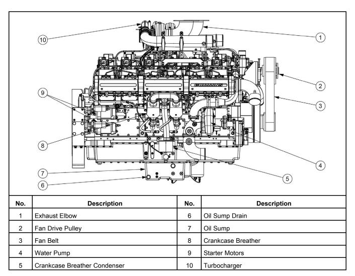
FIGURE 4. TYPICAL QSK38-G18 ENGINE COMPONENTS - LEFT VIEW
