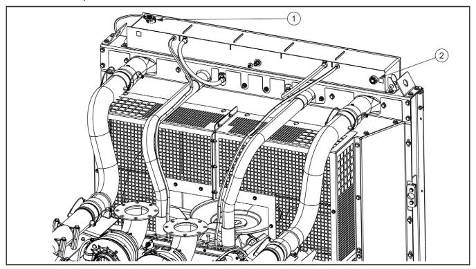
FIGURE 51. HEADER TANK
