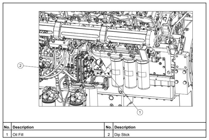
FIGURE 57. ENGINE OIL FILL LOCATION
