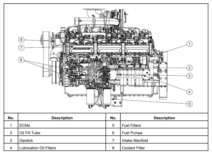
FIGURE 3. TYPICAL QSK38-G18 ENGINE COMPONENTS - RIGHT VIEW
