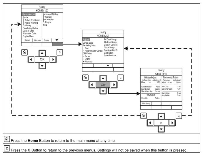
FIGURE 24. ADJUST MENU - TYPICAL DATA
