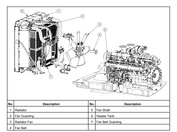
FIGURE 5. COOLING SYSTEM
