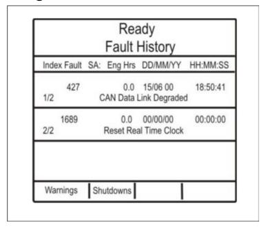
FIGURE 21. FAULT MESSAGE DISPLAY SCREEN
