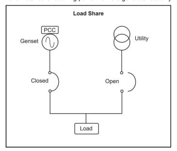
FIGURE 39. MANUAL MODE - CIRCUIT BREAKER CONTROL SEQUENCE 3
