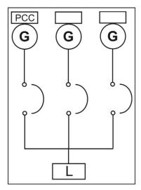
FIGURE 34. ISOLATED BUS ONLY - STANDBY PARALLELING STATE
