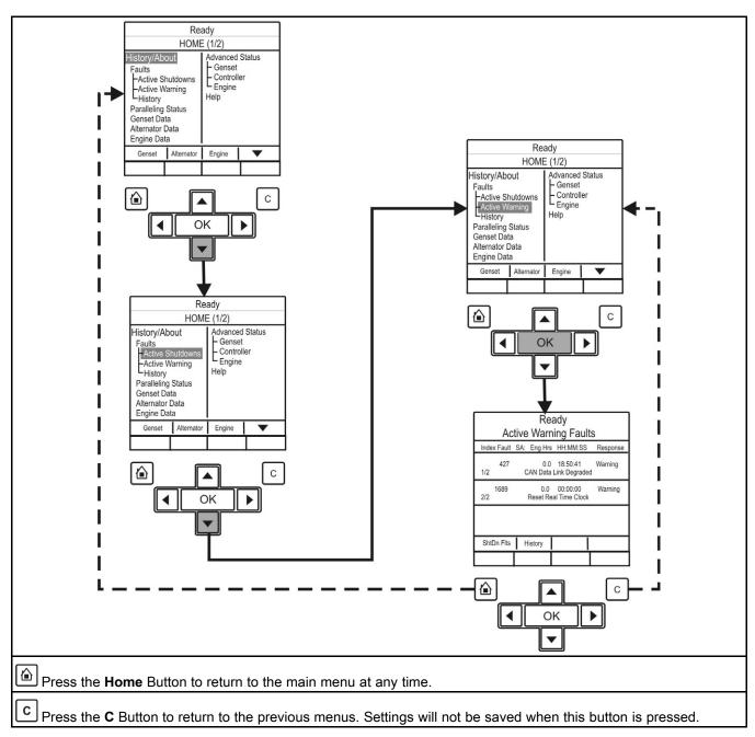
FIGURE 22. WARNING FAULT MENU - TYPICAL DATA
