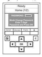
FIGURE 30. MODE CHANGE ACCESS CODE DISPLAY SCREEN
