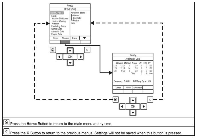
FIGURE 19. ALTERNATOR DATA MENU - TYPICAL DATA
