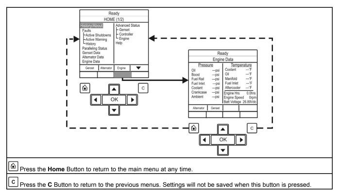
FIGURE 17. ENGINE DATA MENU - TYPICAL DATA
