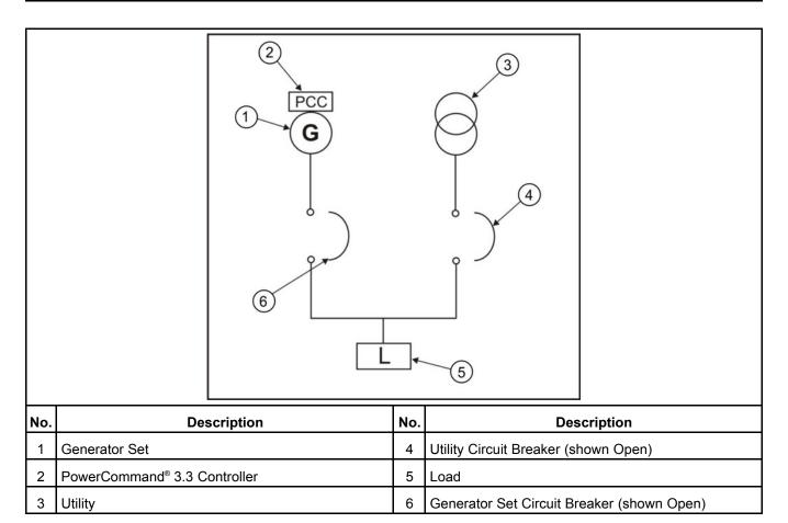
FIGURE 37. MANUAL MODE - CIRCUIT BREAKER CONTROL SEQUENCE 1
