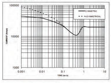
THE FOLLOWING MULTIPUICATION FACTORS SHOULD BE USED TO ADJUST THE VALUES FROM CURVES BETWEEN THE 0.051 SECONDS AND THE MINIMUM CURRENT POINT IN RESPECT OF NOMINAL OPERATING VOLTAGE VOLTAGE FACTOR 360V X 0.05 400V X 1.00
