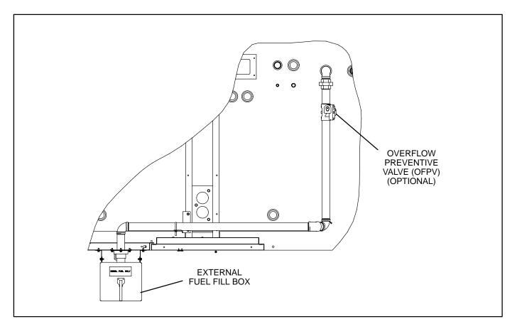
FIGURE 5-7. OPTIONAL FUEL (SPILL) FILL BOX
