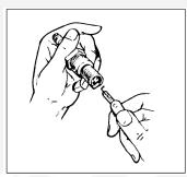
FIGURE 29. GAPING SPARK PLUG
