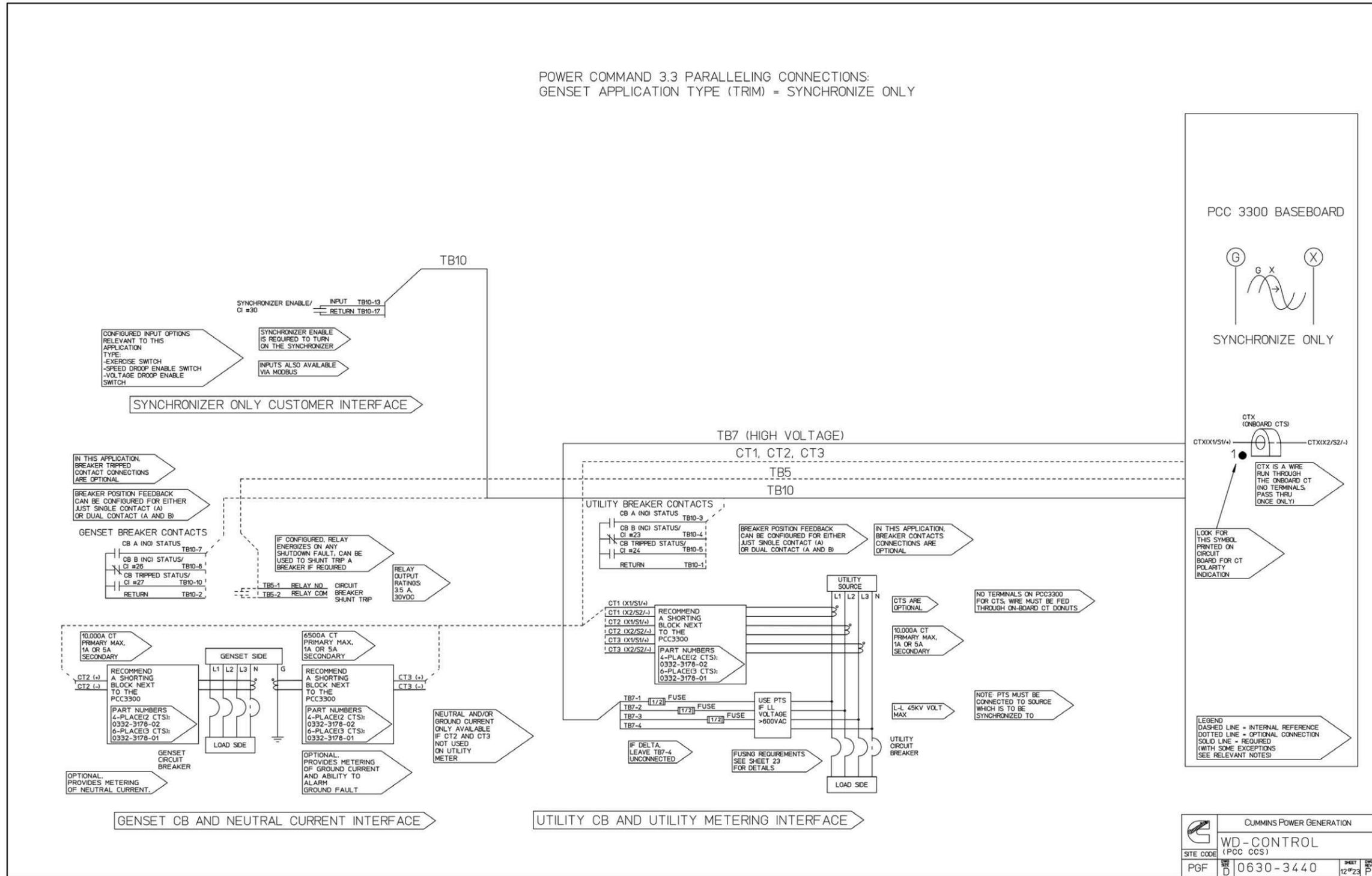
FIGURE 53. POWERCOMMAND 3.3 PARALLELING CONNECTIONS - SYNCHRONIZE ONLY
