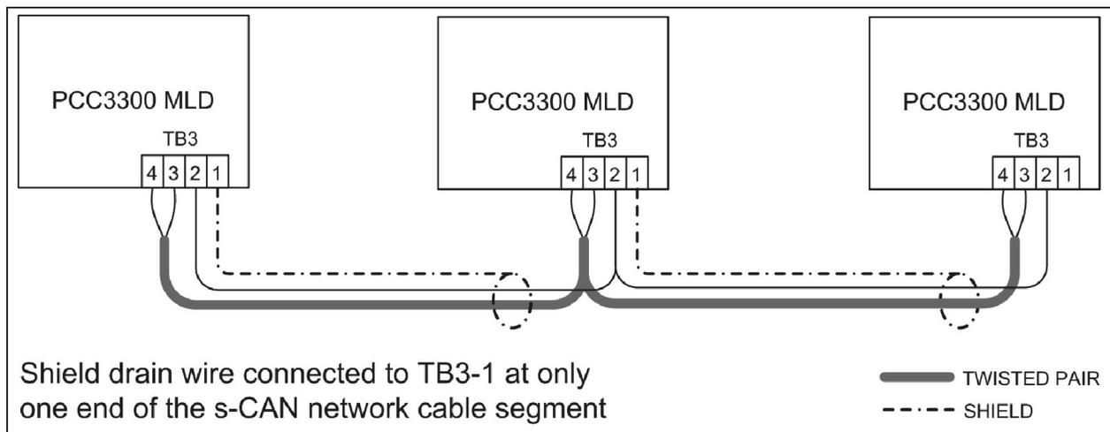
FIGURE 29. SHIELD CONNECTIONS ON MLD S-CAN NETWORK
