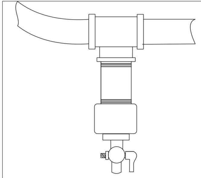
**FIGURE 15. CONDENSATION TRAP**
