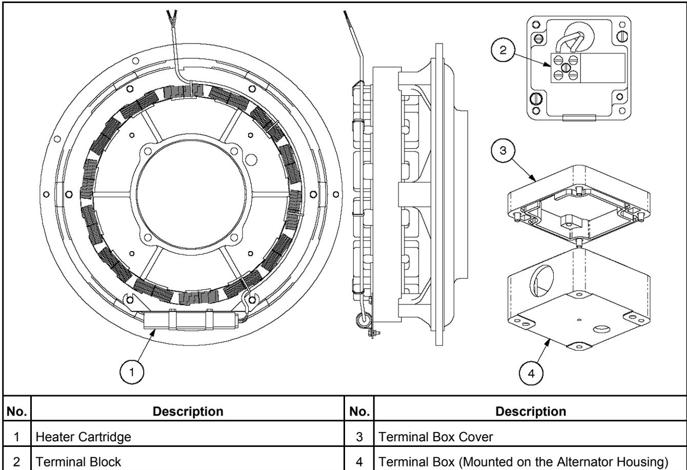
FIGURE 23. TYPICAL ALTERNATOR HEATER
