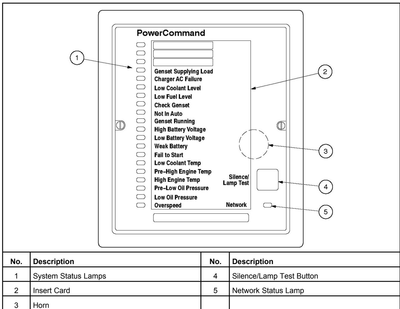
FIGURE 28. ANNUNCIATOR COMPONENTS
