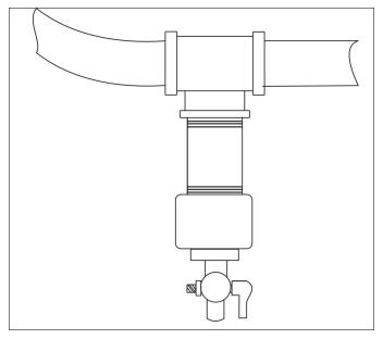
FIGURE 15. CONDENSATION TRAP
