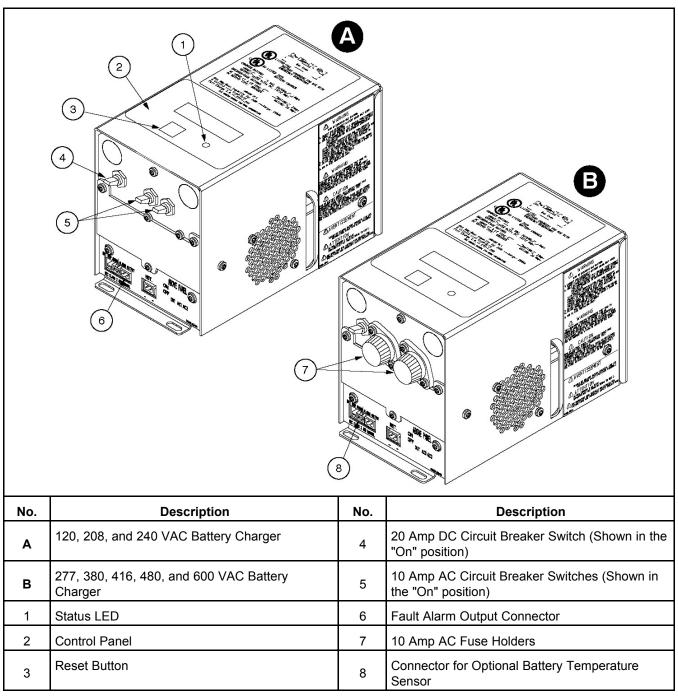
FIGURE 24. 15/12-AMP POWERCOMMAND BATTERY CHARGERS
