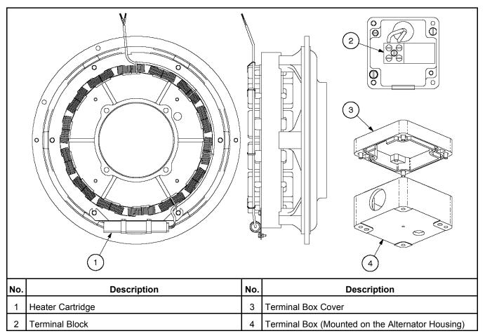
FIGURE 23. TYPICAL ALTERNATOR HEATER
