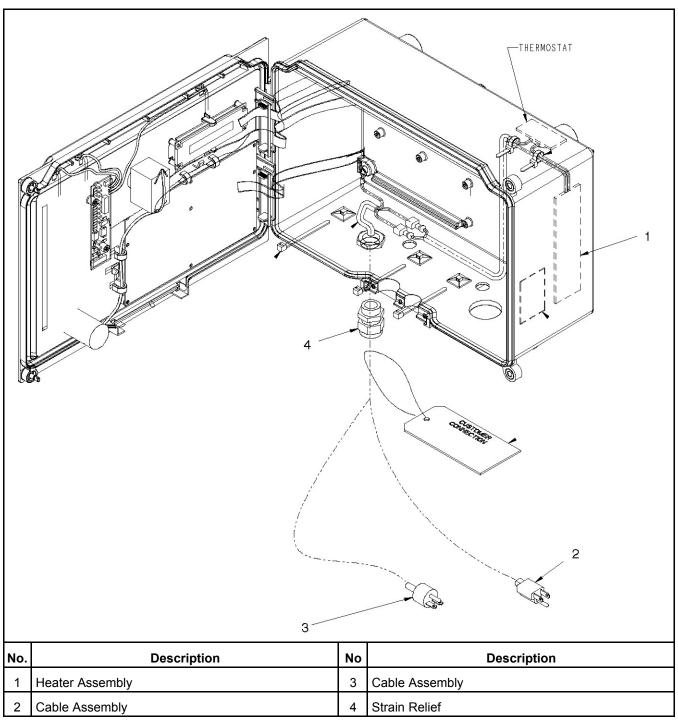
FIGURE 4. TYPICAL CONTROL CABINET HEATER
